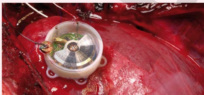
Abb. 2: Epikardialer batterieloser Herzschrittmacher in linksventrikulärer apikaler Position. Dieser Prototyp beinhaltet ein für diese Zwecke angepasstes Uhrwerk. Die Schwungmasse wurde optimiert um möglichst viel der mechanischen Herzbewegung in elektrische Energie umzusetzen. Die Energie wird von der Elektronik (grünes Bauteil) verarbeitet um das Herz mit Schrittmacherimpulsen zu stimulieren. Ein Magnet (goldfarben, links am Rand des Prototyps) wird in diesem Versuch verwendet um den Schrittmacher während der Implantation zu inhibieren.
