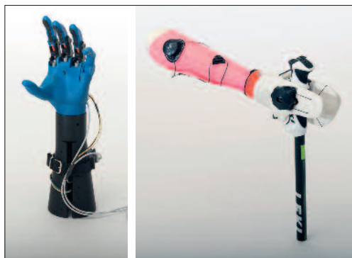
Universalthandprothese (links) und Handprothese zum Skilaufen (rechts) aus dem 3D-Drucker (Fotos: ZHAW)
