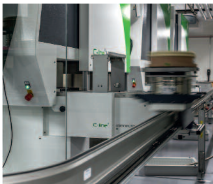
Transportsystem für die gefrorenen Proben: Der mit Flüssigstickstoff gekühlte Transportbehälter wird auf einem Schienensystem an den Zielort der Fracht gefahren, wo die Proben automatisch bei minus 150 Grad Celsius eingelagert werden. (Foto: © Insel Gruppe/Pascal Gugler)
